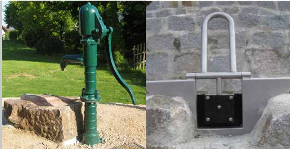
Schwengelpumpe und Klappwehr
